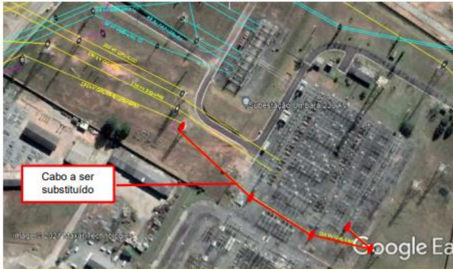
FIGURA 05 – Croqui do trecho de substituição do cabo da LT GRL-UMB na SE Umbará
